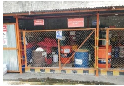
Ilustración 11 Área de transferencia de residuos sólidos, aceites y residuos especiales generados en la empresa Rambal S.A.S.
